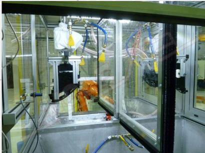
I pezzi da floccare sono sostenuti da un piano traslante: l'operatore posiziona l'oggetto ed il piano trasla portandolo in posizione di floccatura.
