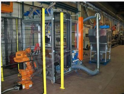
La cabina è in grado di floccare una grande varietà di oggetti di forme differenti. Il processo è completamente automatico e la pistola elettro-pneumatica per il floccaggio è attaccata al braccio mobile del robot, rendendo possibile registrare i movimenti per floccare oggetti diversi.
