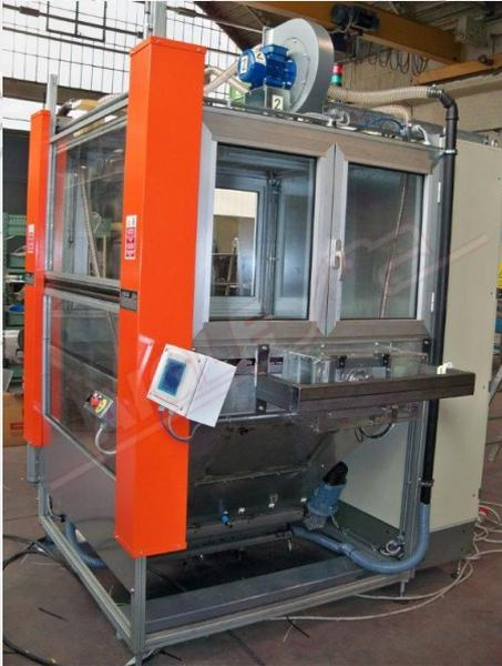
La cabina fa parte di una serie di macchine e di linee specificatamente studiate per floccare oggetti in serie. Particolare attenzione è stata riservata al settore dell'automotive che richiede alti standard:
