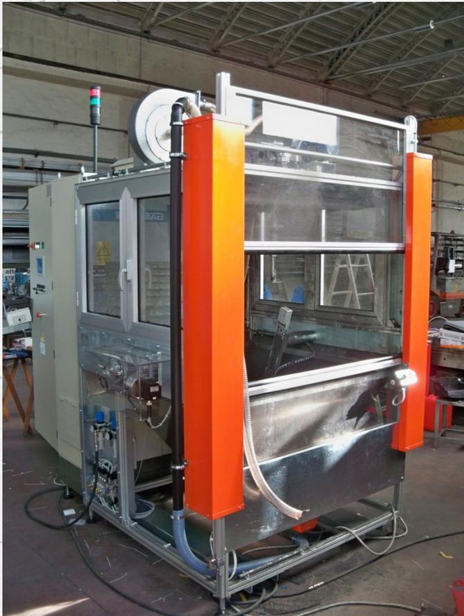
La **Cabina di Floccaggio Automatica per Oggetti 3D - mod. CA-ESP** è in grado di floccare una grande varietà di oggetti di forme differenti.
