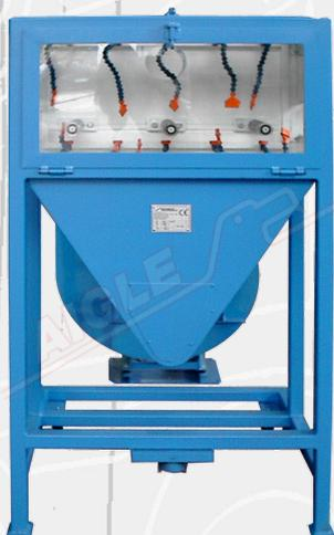
Il **Gruppo di Aspirazione & Pre-pulizia mod. PRCP e mod. Jet-Matic** viene sistemato dopo la floccatrice, in modo da garantire una buona prepulizia del profilo prima dell'ingresso nel forno e per evitare, inoltre, un'eccessiva dispersione di flock durante le varie fasi lavorative.
