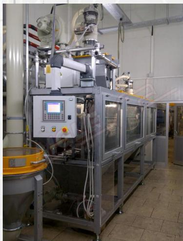
L'unità **Jet-Matic** è composta da una serie di ugelli ad aria compressa, sistemati sopra e sotto il profilo. Flusso e pressione dell'aria, nonché orientamento degli ugelli, sono facilmente regolabili. L'unità è collegata al sistema di aspirazione centrale tramite tubi flessibili. Tale sistema è normalmente composto da un aspiratore collegato alle uscite dell'aria, alle tramogge aspiranti delle floccatrici e ad un filtro ad ampia superficie integrato nel sistema di condizionamento.
