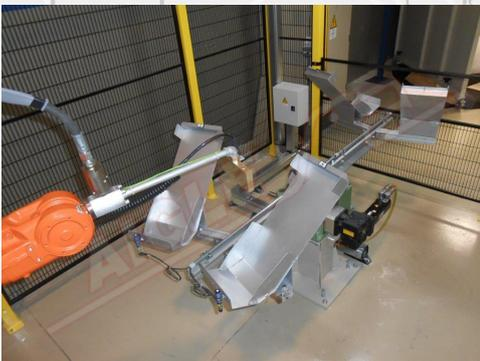
La cabina è in grado di trattare una grande varietà di oggetti di forme differenti. Il processo è completamente automatico ed avviene per mezzo di un robot. I pezzi da trattare sono collocati su un piano rotante: l'operatore vi sistema l'oggetto ed il tavolo ruota portandolo in posizione di trattamento al plasma automatico; nell'altra posizione il pezzo è pronto per l'operazione di carico/scarico.
