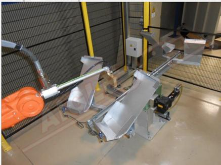
Avec ce meuble, il est possible de flamber une variété d'objets de différentes formes. Le processus est entièrement automatisé et réalisé par un robot. Les objets sont fixés sur une table tournante : l'opérateur place l'objet, puis la table tourne jusqu'à la position de flambage ; l'autre côté est prêt pour les opérations de chargement/déchargement et le côté opposé est prêt pour le processus de flambage automatique.
