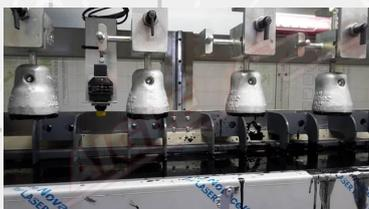
Toda la instalación está configurada para permitir esta flexibilidad. Un sistema de transportadores de cadena paso a paso permite organizar de forma óptima el proceso de producción. La máquina de aplicación de adhesivo está equipada con almohadillas especiales. La flocadora está equipada con pistolas electroneumáticas para la correcta distribución del flock.
