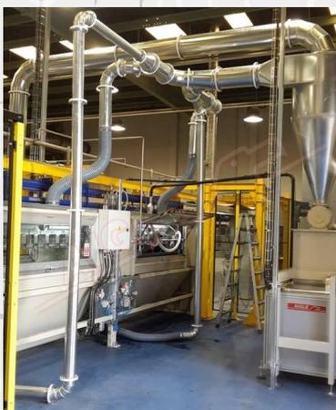
La flocadora está equipada con un sistema de recogida y recirculación del exceso de floc mediante colectores conectados a sistemas de aspiración. También hay un sistema de acumulación de producto en el interior del horno para garantizar un tiempo de secado suficiente. Aigle también ofrece instalaciones semiautomáticas y manuales.
