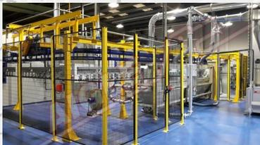
A lo largo de los años, **AIGLE** ha desarrollado varias instalaciones para el flocado de campanas asilantes de hierro fundido. El aislante está flocado en la abertura para evitar la fricción con otros materiales con los que se espera que entre en contacto durante el funcionamiento.
