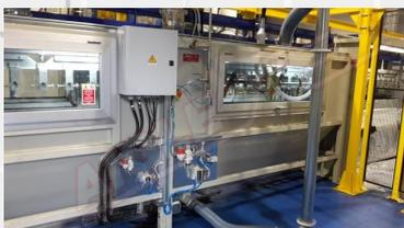
El flocado se aplica entonces de forma precisa y uniforme. En los sistemas automáticos, todos los pasos se realizan sin intervención del operario: aplicación del adhesivo, flocado, limpieza previa, secado, enfriamiento y limpieza final. Sólo la carga y descarga de piezas se realiza manualmente. Las piezas en bruto se colocan en soportes especiales diseñados para campanas de diferentes tamaños y dimensiones.
