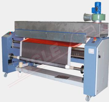
Il Forno per Plotter Tessile Digitale mod. PLOTTER-HEAT è un innovativo gruppo di essiccazione per tessuti stampati con tecnologia digitale. L'unità può essere installata in uscita di un plotter tessile digitale. Le principali caratteristiche dell'unità sono:
