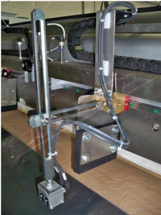
Das Gerät kann sowohl für die Luftbeschichtung als auch für die Beschichtung auf dem Zylinder verwendet werden und ist mit einer motorisierten Vorrichtung ausgestattet, die die Beschichtungsdicke über digitale Anzeigen einstellt und die Klinge anhebt, wenn die Verbindungsstelle durchläuft.
