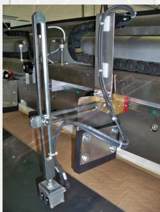
НАНЕСЕНИЕ ПОКРЫТИЙ мод. BSR/C используется для нанесения покрытий на бумагу (с помощью смолы и/или клея).
