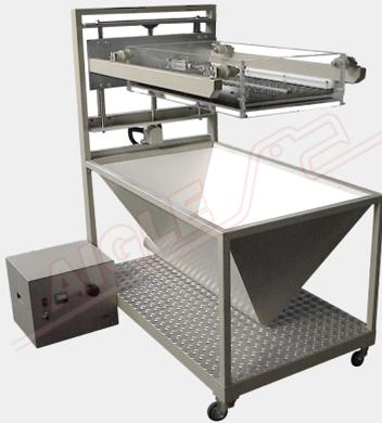
Die **Beflockung Maschine mod. AN** ist für die Beflockung von T-Shirts konzipiert und kann auf handelsüblichen Karusselldruckern angebracht werden. Er kann in zwei verschiedenen Versionen geliefert werden, mit oder ohne Flockensammler oder Absaugung.
