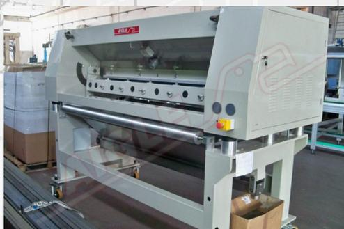
Сайт **Устройство распределения порошка мод. TDP/M** состоит из одного бункера с порошком, в основании которого установлен дозирующий цилиндр с инверторным управлением и регулируемой частотой вращения.
