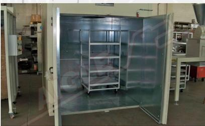
Das **Heizsystem** ist mit elektrischen Edelstahl-Heizkörpern ausgestattet, die für Umluft geeignet sind, gerippt und so angeordnet, dass ein optimaler Wärmeaustausch gewährleistet ist. Die Kontrolle und Einstellung der Temperaturen erfolgt über einen digitalen Thermoregler auf der Steuerplatine.
