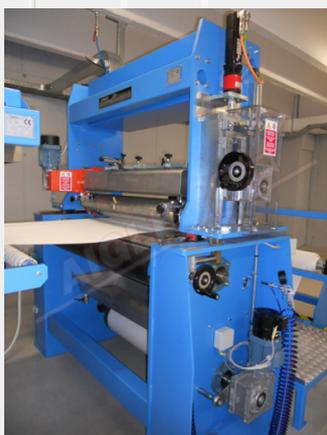
Установка может быть использована для нанесения покрытия на лопатки на воздухе, нанесения покрытия на цилиндр и реверсивный вал. Он оснащен очень точным моторизованным устройством, позволяющим регулировать толщину покрытия с помощью цифровых дисплеев и поднимать лезвие/цилиндр при прохождении шва.
