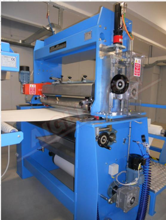
Die **Beschichtungsmaschine mod. BSR/R** wird zur Beschichtung von Gewebe, Papier und TNT (mit Harz und Klebstoffen) verwendet.
