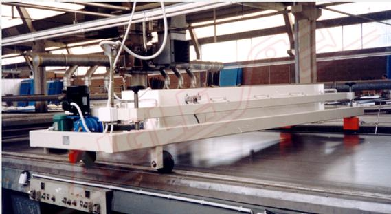
Die **Beflockung Trolley mod. TCR/COMPL** auf den Endschultern einer Flachsiebdruckmaschine montiert werden muss. Der Beflockungswagen läuft auf zwei Schienen, die an den Schultern der Druckmaschine befestigt sind, hin und her. Die Geschwindigkeiten von Wagen und Druckmaschine sind synchronisiert. Während das Gewebe zwischen den Druckphasen anhält, beflockt der Wagen das darunter liegende Gewebe.
