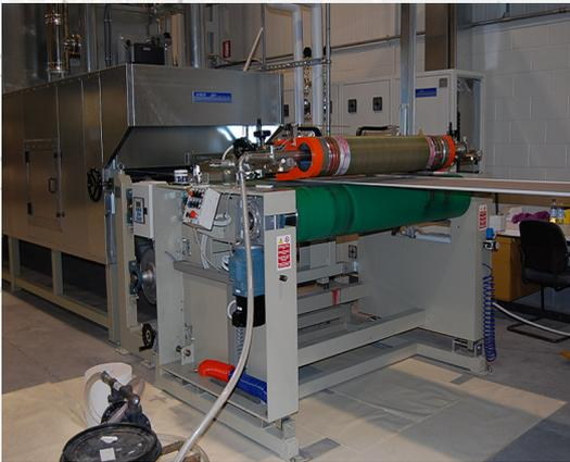
Die **Rotationssiebbeschichtungsanlage mod. BS1/T** wird zur Beschichtung und zum Bedrucken von Stoffen (mit Pigmenten, Harz und Klebstoffen) sowie zur Beflockung von Mustern verwendet.
