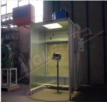
Сайт **Шкаф для нанесения клея мод. CV** закрыт с трех сторон и открыт спереди.
