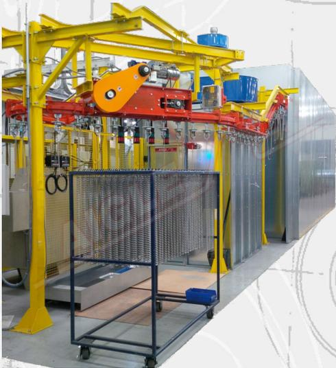
**AIGLE** ha sviluppato nel corso degli anni diversi impianti di **Floccaggio per Molle Metalliche**, utilizzate in prevalenza nel settore automobilistico. Le molle floccate vengono impiegate nei sistemi di apertura delle porte. Il flock diminuisce la rumorosità nell'abitacolo ed aiuta lo scorrimento della molla all'interno della sua sede.
