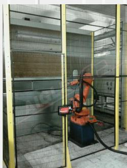
С помощью этого шкафа можно распылять разнообразные предметы различной формы. Процесс полностью автоматизирован и осуществляется роботом.
