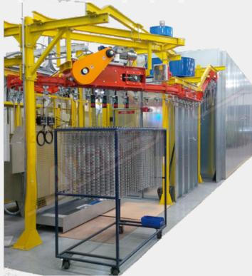
**AIGLE** ha sviluppato nel corso degli anni diversi **Impianti di Verniciatura per Molle Metalliche** utilizzate in prevalenza nel settore automobilistico. Le molle verniciate vengono impiegate nei sistemi di apertura delle porte. La vernice protegge la molla dall'usura nel corso del tempo.
