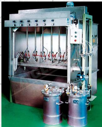
La **Cabina Applicazione Colla mod. ADP6** è costruita interamente in acciaio inossidabile ed è dotata di ventilatore anti-scintilla per i vapori della colla.
