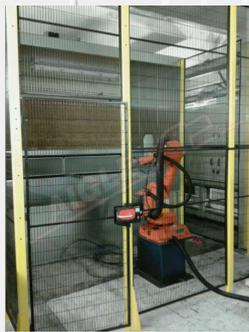
La cabina è in grado di verniciare una grande varietà di oggetti di forme differenti. Il processo è completamente automatico ed avviene per mezzo di un robot. E' possibile infatti registrare i movimenti per verniciare oggetti diversi.
