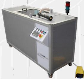
Il **Gruppo Distributore Elettro-Pneumatico di Flock mod. ESP1** è indicato soprattutto per il floccaggio di parti interne.
