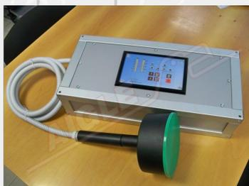
A caratterizzare la macchina sono l'elettronica altamente affidabile, la tensione erogata stabile e costante, indipendente dalle condizioni di lavoro della floccatrice, e l'ampere regolabile.
