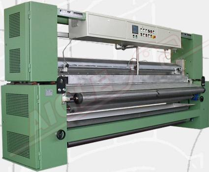
La machine à enduire mod. Le BSR/C est utilisé pour l'enduction sur papier (avec de la résine et/ou des adhésifs).
