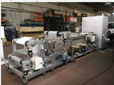
Des systèmes permettant de détacher la membrane coagulée du substrat sont également utilisés dans cette ligne.
