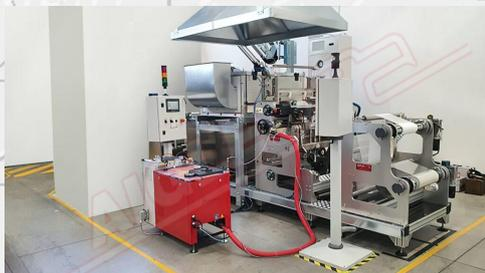
Les lignes de coagulation sont utilisées pour la production de filtres et de cuir synthétique. Il s'agit d'un processus humide. Le substrat est d'abord imprégné, pressé ou fendu, puis mis en contact avec de l'eau diluée avec d'autres composés chimiques.
