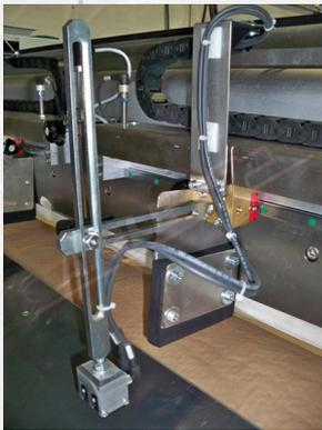
La unidad puede utilizarse tanto para el recubrimiento por aire como para el recubrimiento sobre cilindro y está equipada con un dispositivo motorizado para ajustar el grosor del recubrimiento mediante pantallas digitales, y para levantar la cuchilla cuando pasa la unión.
