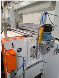
Le **système d'enduction pour le prétraitement des tissus en vue de l'impression numérique** consiste à appliquer une couche de racle sur un tissu afin d'améliorer la qualité de l'impression numérique.
