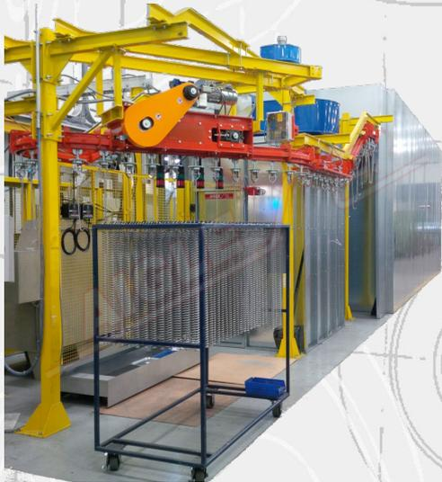
Au fil des années, **AIGLE** a développé plusieurs équipements de peinture pour les ressorts métalliques, utilisés principalement dans l'industrie automobile. Les ressorts peints sont utilisés dans les systèmes d'ouverture des portes. La peinture protège le ressort de l'usure du temps.
