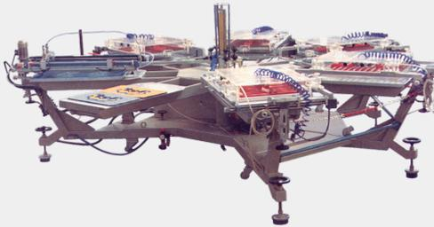
**Machines à floquer mod. TO/S** sont conçus pour floquer des t-shirts et des feuilles et peuvent être montés sur des imprimantes carrousel courantes.
