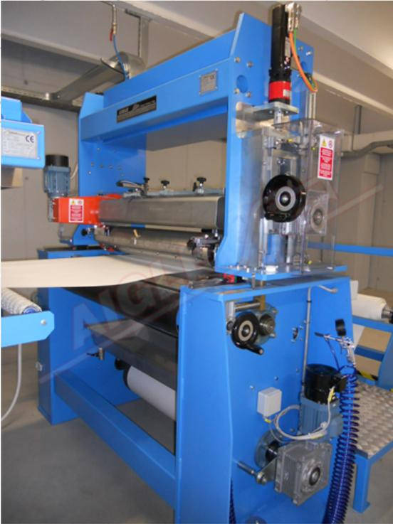
El **Máquina de revestimiento mod. BSR/R** se utiliza para recubrir tela, papel y TNT (con resina y adhesivos).
