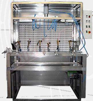
Une pompe péristaltique très précise applique la colle sur les brosses. La cabine est équipée de portes d'inspection à l'arrière pour faciliter le nettoyage, l'entretien et le remplacement des filtres. Un éclairage interne est également prévu.
