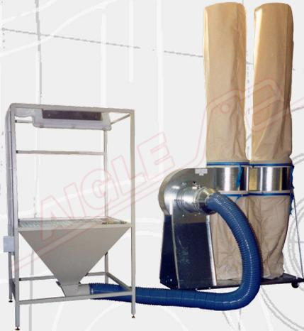
Les **Armoire de pulvérisation/nettoyage de flocons mod. CA** est fermé sur trois côtés et ouvert sur le devant.
