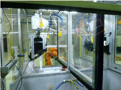
La cabina está equipada con un sistema de flocado electroneumático mod. ESP (consulte el folleto correspondiente) y con un sistema automático de cribado y recuperación de flock.
