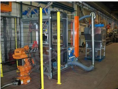
Con esta cabina, es posible flocar una gran variedad de objetos de diferentes formas. El proceso es completamente automático. La pistola de flocado se coloca en el brazo de un robot para poder grabar movimientos específicos y reproducirlos fácilmente. Los objetos se apoyan en una mesa de traslación: el operario coloca el objeto y, a continuación, la mesa se traslada a la posición de flocado.
