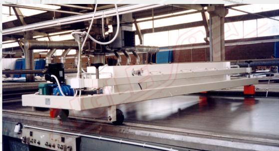
Les **Chariot de floccage mod. TCR/COMPL** doit être assemblé sur les épaules d'une machine de sérigraphie à plat. Le chariot de floccage fait des allers-retours sur deux rails montés sur les épaules de la machine d'impression. Les vitesses du chariot et de la machine d'impression sont synchronisées. Pendant que le tissu s'arrête entre les phases d'impression, le chariot floque le tissu qui se trouve en dessous.
