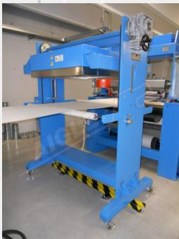
El **horno de presecado por infrarrojos** ha sido diseñado para diferentes propósitos:
