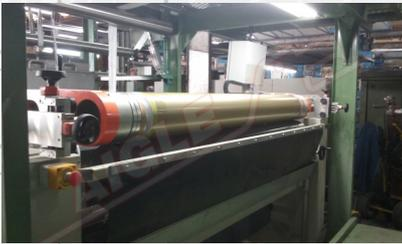
Les **Modèle d'enrobeuse de tamis rotatif. BS1** est utilisé pour l'enduction et l'impression de tissus (avec des pigments, de la résine et des adhésifs) et pour le floccage de motifs.
