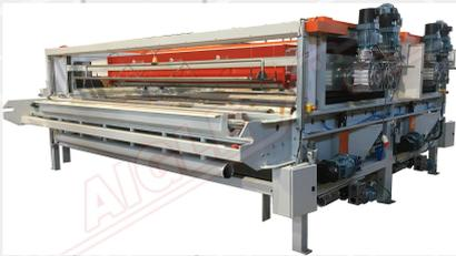
Die Beflockungsmaschinen der FR-Serie können auch mit automatischen Systemen für die Rückgewinnung der Flockklumpen ausgestattet werden: Spezielle Düsen gewinnen die Verunreinigungen in den Trichtern zurück, indem sie sie durch ein entsprechendes Sieb leiten.
