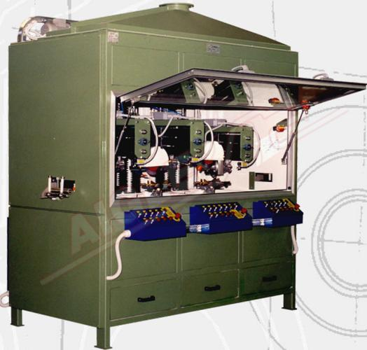
Las **Muelas mod. SUC3 y SUC2+1** se fabrican específicamente para lijar superficies perfiladas en las que se depositarán adhesivos.
