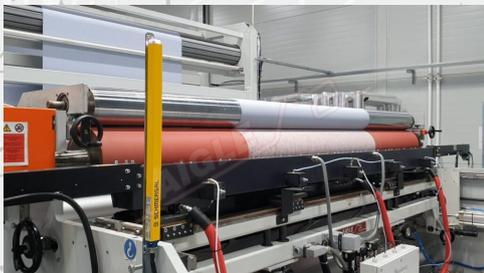
Sistemi di applicazione per **linee accoppiatura hot-melt**: **Sistema con cilindro liscio** o **inciso** **Sistema con slot**.
