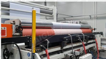
Системы нанесения для **линий соединения горячего расплава: Система с гладким или гравированным цилиндром Система с прорезями**
