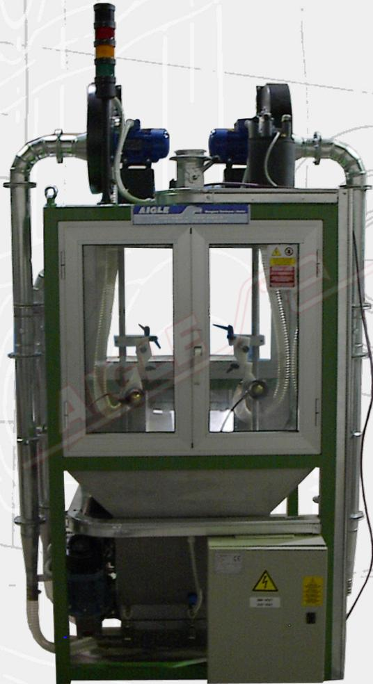
Die **Elektropneumatische Beflockungsmaschine mod. FR/ESP** ist für die Beflockung von Profilen mit Hinterschnidungen konzipiert.
