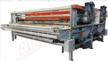
ФЛОК серии FR также может быть оснащен автоматическими системами восстановления комков флока: специальные форсунки удаляют все примеси, находящиеся в бункерах, пропуская их через соответствующее сито.
