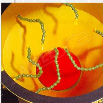
Il Gruppo di Aspirazione & Pre-pulizia mod. PRCP e mod. Jet-Matic viene sistemato dopo la floccatrice, in modo da garantire una buona prepulizia del profilo prima dell'ingresso nel forno e per evitare, inoltre, un'eccessiva dispersione di flock durante le varie fasi lavorative.
