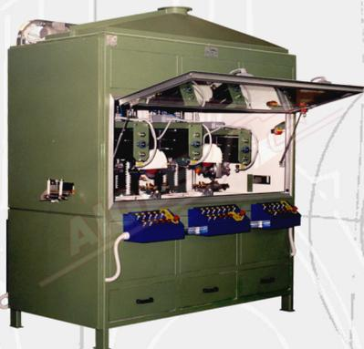
Le **Smerigliatrici mod. SUC3** e **mod. SUC2+1** sono utilizzate per preparare la superficie del profilo alla spalmatura della colla.
