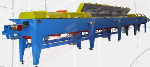
Le **Four de séchage à air chaud mod. FAC12** est divisé en quatre travées de trois mètres chacune et chauffe les profilés à l'air chaud. Chaque baie est équipée de batteries électriques à tubes à ailettes en acier inoxydable, de conduits de distribution d'air et de ventilateurs de recirculation.
