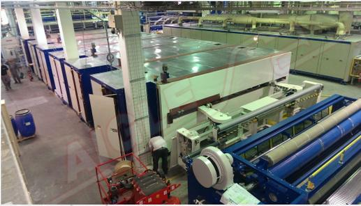
Tanto las puertas laterales como los paneles superiores son de acero galvanizado con lana mineral de alta densidad. El horno está construido para garantizar el máximo aislamiento.
