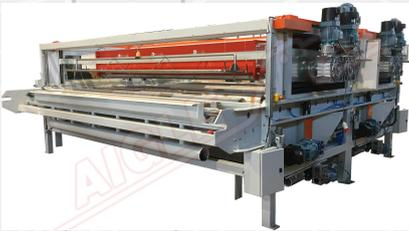
Las flocadoras de la serie FR también pueden equiparse con sistemas automáticos para la recuperación de los grumos del flock: unas boquillas especiales recuperan las impurezas existentes en las tolvas haciéndolas pasar por un tamiz adecuado.
