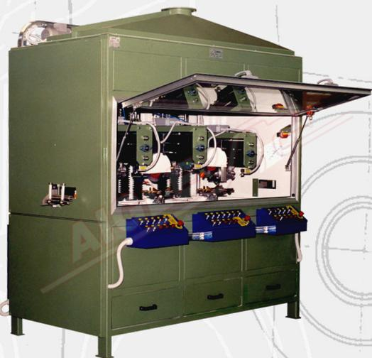
Les **Machines à poncer mod. SUC3 et SUC2+1** sont spécialement conçus pour poncer les surfaces profilées sur lesquelles des adhésifs seront déposés.
