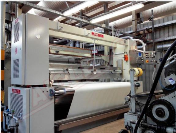
El papel, tras desprenderse de la piel sintética, se rebobina cuidadosamente y se reutiliza varias veces en el proceso de producción hasta que es necesario sustituirlo.
